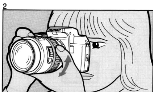
1. レンズのオートズームスイッチを[AS](一部のレンズでは[MODE])側に押し付けたままTvダイレクトダイヤルを回して、表示パネルの[■]表示を点滅させてください。
