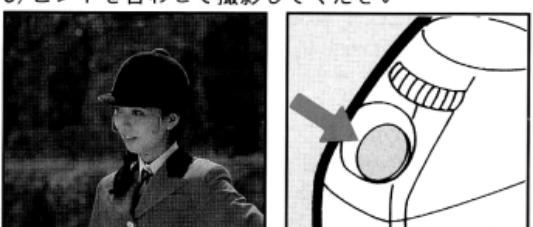
写したいもの(被写体)をA Fフレーム [ ] に合わせて、シャッターボタンを静かに押して撮影します。(29ページ)
