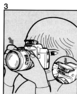
1. 図のように、ストロボスイッチを押して、ストロボを上に飛び出させます。
