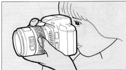
1. レンズのオートズームスイッチを **[AS]** (一部レンズでは **[MODE]**) 側に押し付けたままセレクトダイヤルを回して、表示パネルに **[Z]** マークを点滅させてください。
