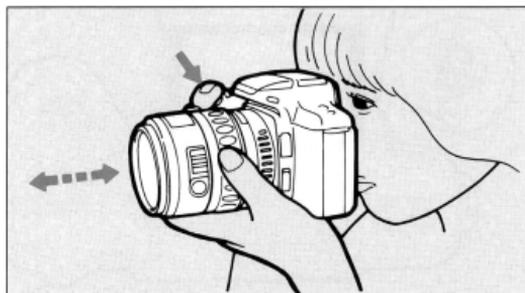
4. シャッターボタンを半押しすると、撮影距離が変わっても被写体の大きさが一定になるように自動的にズームします。ズームが終了してからシャッターボタンを押し切って撮影してください。
