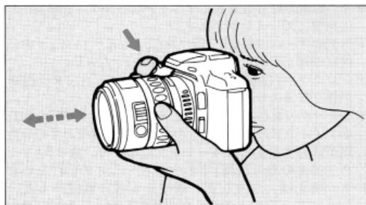
3. シャッターボタンを押し切ると、そのときのシャッター速度に応じて露光間ズームを行ない撮影します。
