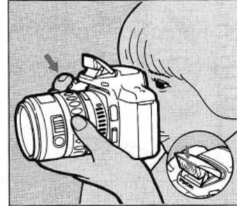
1. 図のように、ストロボスイッチを押して、ストロボを上に飛び出させます。
