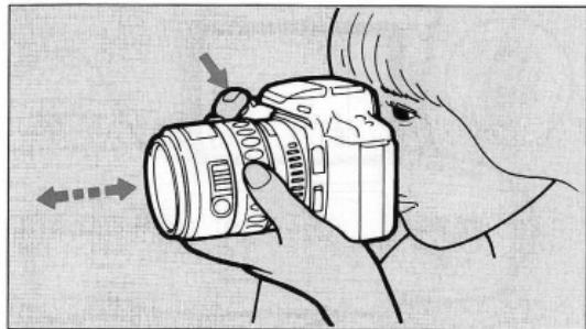
4. シャッターボタンを半押しすると、撮影距離が変わっても被写体の大きさが一定になるように自動的にズーミングします。ズーミングが終了してからシャッターボタンを押し切って撮影してください。
