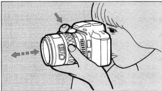
3. シャッターボタンを押し切ると、そのときのシャッター速度に応じて露光間ズームを行ない撮影します。
