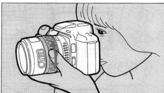
1. レンズのオートズームスイッチを [A S] 側に押し付けたままセレクトダイヤルを回して、表示パネルに [ ] マークを点滅させてください。
