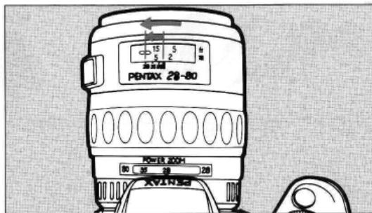
赤外線フィルムと「R 2」や「O 2」フィルターを使用して赤外線写真を撮影するときは、一般撮影[可視光線]とピント位置が異なってくるため、ピントの補正が必要になります。オートフォーカスでは赤外線写真のピント補正ができません。一度普通にピント合わせをしてから、フォーカスモードレバーを **MF** にし、距離リングを赤外線指標の分だけ左に回して補正します。
