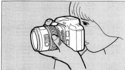
2. ズームリングを操作し、撮影意図に合うような広角側の焦点距離にしてください。
