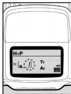
5. 裏ぶたを閉め電源スイッチを **ON** か **USER** にすると、自動的に巻き上げられます。表示パネルに **[E]** と **[0---** が出ていることを確認します。
