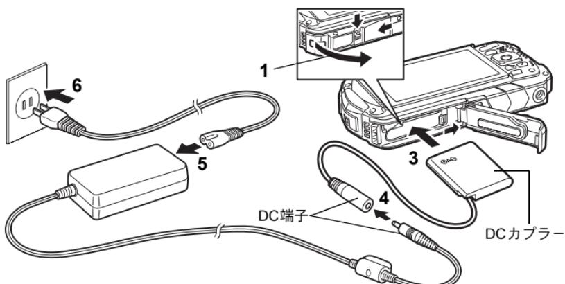
**1** カメラの電源が切れていることを確認してから、バッテリー／カードカバーを開ける
