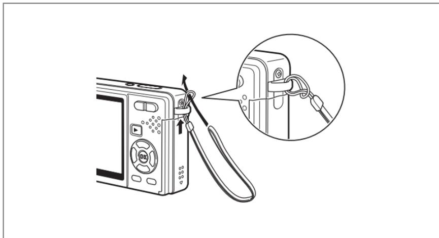
ストラップの細いひもを、ストラップ取り付け部に通して取り付けます。
