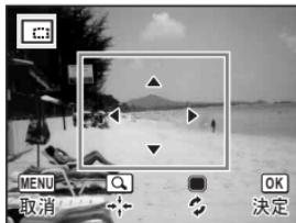
以下の操作で緑の枠を動かして、画面のどの部分をトリミングするか決めます。
