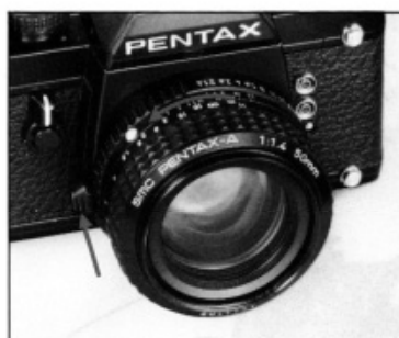
4. レンズをはずすときはレンズロックレバーをボディー側に押しながら、レンズを左に回すとはずせます。
