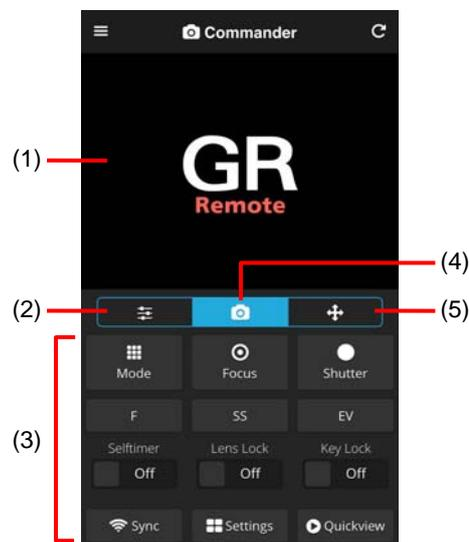
左／中央／右のタブを切り替えてボタンを操作します。
