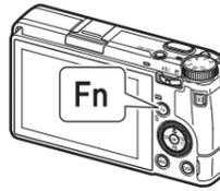
Die Funktion von Fn kann im Menü C2 unter [Funktionstaste-Eins.] geändert werden. Standardmäßig ist [HDF] eingestellt.
