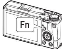
Fn 功能可以在 [C]2 菜单的 [Fn 按钮设定] 中进行更改，而初始设定中已设为 [HDF]。
