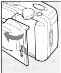
2. 表示パネルの **0** の点滅を確認してから、図のように裏ぶたを開けます。
