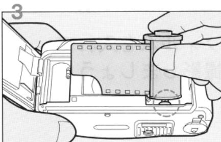
3. フィルムは凸側を上にして、下側から先に黒い突起に差し込むように入れ、次に上側を押し入れます。
