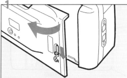
1. 図のように、裏ぶた開放レバーを下方向に押し下げ、裏ぶたを開けます。
