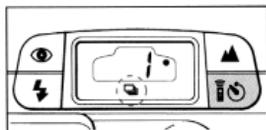
セルフ/撮影モードボタンを押して、表示パネルに
