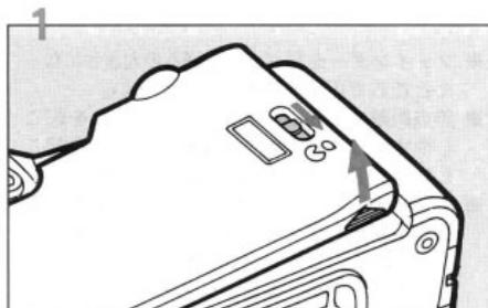
1. 図のように、裏ぶたの開閉レバーを下方向に押し下げ、裏ぶたを手前に引いて開けます。
