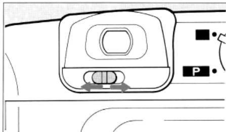
カメラを明るい方へ向けて、図のように視度調整レバーを左右に動かし、ファインダー内中央のオートフォーカスフレームの線が最もはっきり見える位置に調節します。
