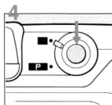
電源スイッチを押して電源をONにします。
