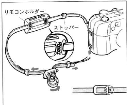
ストラップはストッパーから先端までの長さが短い方を図のようにストラップ通しの上方から差し込んで取り付けます。[長い方から差し込みますとスーパーマクロ撮影時の撮影距離が正しく測れません。]
