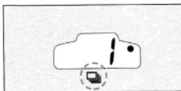
セルフ／撮影モードボタンを押して、表示パネルに 表示を出して撮影します。
