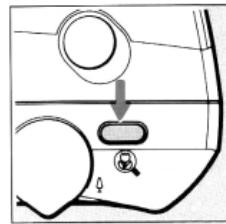
スーパーマクロボタンを押し、表示パネルに 表示を出して撮影します。スーパーマクロは0.45m【固定】の接写ができ、サービスサイズにプリントしたとき、ほぼ実物大になる大きさに写ります。
