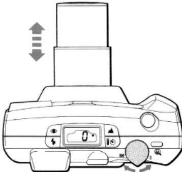
ズームレバーを 側に回すと、遠くのものを大きく写せる110mm望遠側へ、 側に回すと広い範囲を写せる38mm広角側へ動きます。ファインターを見ながら、好みの構図になったところで止めて撮影してください。
