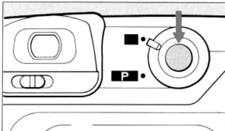
スイッチを押すと電源が入り[電源ON]、レンズが少し前に出てレンズカバーが開きます。
