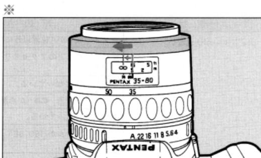
赤外線フィルムと「R2」や「O2」フィルターを使用して赤外線写真を撮影するときは、一般撮影[可視光線]とピント位置が異なってくるため、ピントの補正が必要になります。
