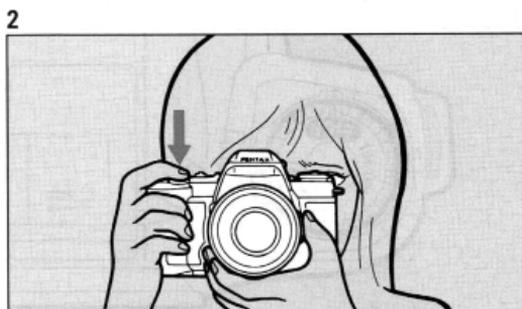
2. シャッターボタンを半押しして写したいものにピントを合わせ、シャッターボタンを押し切るとセルフタイマーが始動します。
