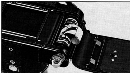
120タイプで10枚、220タイプで20枚撮影した後は、巻き上げてもシャッターがセットされません。さらに数回巻き上げると、完全に巻き取りが終了し、手応えが急に軽くなります。
