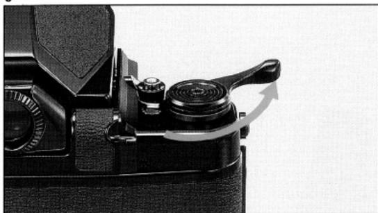
3. カウンター作動盤を押さえたまま裏ぶたを閉じます。巻き上げレバーをいっぱいに戻すとシャッターがセットされます。
