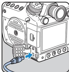
**4** ACコードをACアダプターに接続し、電源プラグをコンセントに差し込む
