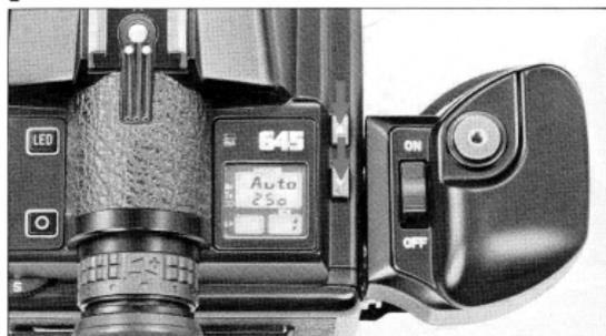
1. シャッター優先自動露出では、外部のLCD表示窓に **Auto**とシャッタースピードが表示されます。他のモードになっているときは、モードボタンを押しながら、セレクトボタン[アップボタン]を押してシャッター優先自動露出表示にしてください。
