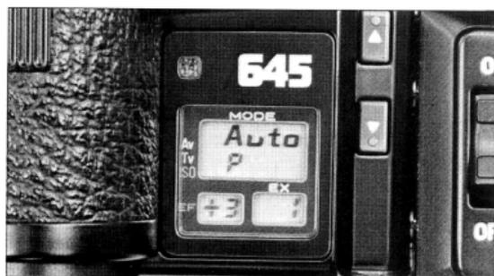
露出補正を使用中は外部のLCD表示窓のEF表示に補正值が表示されます。またファインダー内の絞り表示の上に+または-のLED表示が点滅します。使用後は忘れないうちに0に戻してください。
