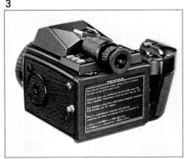
空シャッターをきるときは「フィルムバックをはずした状態」または「ボディ後キャップ645を付けた状態」にします〔レンズなしでも可能〕。
