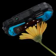
撮りたい被写体に最短で1cmまで近づいて撮影ができる「1cmマクロ」を搭載。瞬時にレンズ円周上のLEDライトを点灯し、マクロ撮影ができる「デジタル顕微鏡」など、マクロ撮影を楽しめる多くの機能を搭載しています。
