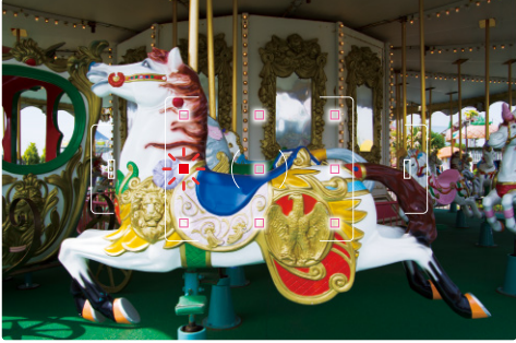
被写体に合わせて、測距点が移動します(スーパーインポーズも移動)。※測距点表示は実際には合焦点のみ点灯します。
