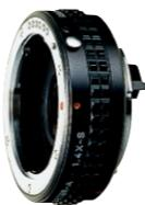
レンズとカメラボディの間に装着し、焦点距離を1.4倍に拡大するコンバージョンレンズです。開放F値は1段暗くなります。また、旅行などで機材をコンパクトに抑えたいときにも有効です。最短撮影距離が主レンズの本来の最短撮影距離と変わらないのも特長。主レンズによっては、近接撮影時、被写体をより大きくクローズアップすることが可能となります。なお、フォーカシングはマニュアルフォーカスとなります。
