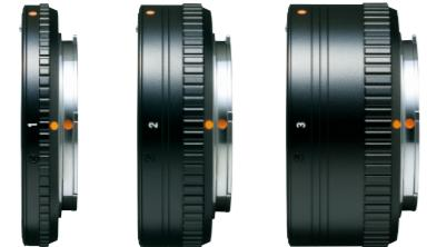
1号(全長9.5mm)、2号(全長19mm)、3号(全長28.5mm)のセット。単独もしくは組み合わせて用い、FA 50mmF1.4の場合、レンズ正向き1号+3号で0.88倍まで、リバースアダプターを用いてレンズを逆向きにすれば1号+2号+3号で1.74倍までの高倍率撮影が可能です。
