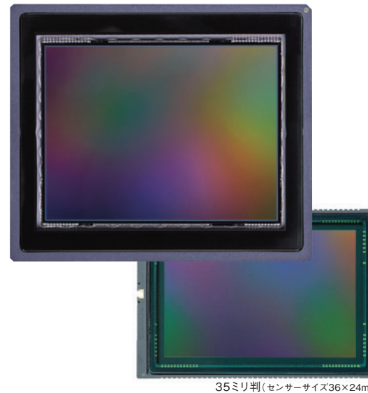
■645Dの44×33mm大型CCDセンサー（原寸）
