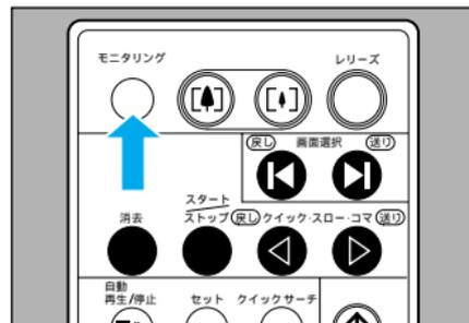
離れた位置や固定した位置にカメラを設置した場合、この機能を使うとカメラから取り込める映像を、テレビで確認できます。リモコンのリリースボタンを使うと、テレビの映像を見ながら撮影することもできます。操作の前に、次のことを確認してください。
