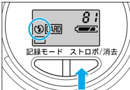
**1** ストロボ/消去ボタンを押して、情報パネルに(🔴)マークを表示させます。リリースボタンを押すと、ストロボを発光しないでメモリーカードに記録します。
