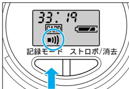
音声を記録するモードです。メモリーカードの残りの容量にあわせて記録できる時間を表示します。
