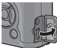
**3** Raccordez l'appareil à une imprimante à l'aide du câble USB fourni.
