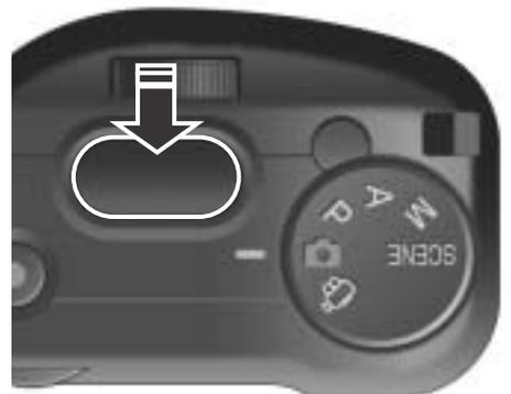
El valor F (valor de apertura) y la velocidad de obturación se muestran en el extremo derecho de la pantalla LCD. El objeto entra en el foco, y la exposición y el balance del blanco serán ajustados. Cuando el enfoque automático falla, el cuadro en el centro de la pantalla LCD se vuelve rojo, y el indicador de enfoque automático/flash que se encuentra en el ángulo superior derecho de la pantalla LCD parpadea de color verde.
