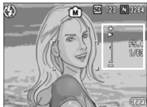
El valor F y la velocidad de obturación serán visualizadas junto con el indicador. El indicador muestra dos límites, +2EV y -2EV. Si se excede de estos límites, el indicador se vuelve anaranjado. Si la diferencia en exposición es dentro de estos límites del indicador, cambia la indicación en la pantalla LCD.
