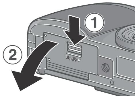
2. Inserte dos pilas, asegurándose de que estén mirando hacia la dirección correcta.
