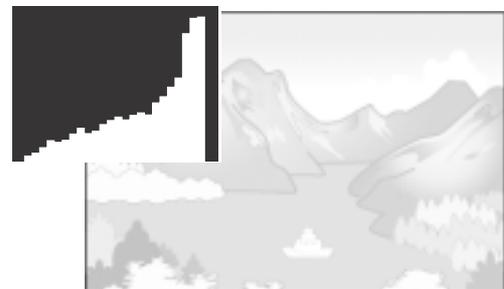
Wenn das Histogramm lediglich Spitzenwerte im linken Bereich anzeigt, so ist das Bild unterbelichtet, zu viele Pixel werden zur Darstellung von Schatten (minimal helle Bildpunkte) verwendet.
