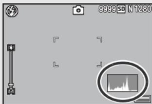
Indem Sie das Histogramm benutzen, können Sie die Helligkeit eines Bildes einschätzen, ohne dabei von der Umgebungshelligkeit der Bildanzeige beeinflusst zu werden. Diese Funktion hilft Ihnen auch, übermäßig helle oder dunkle Bereiche zu korrigieren.
