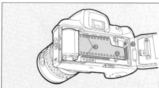
4. 図のように、フィルム先端部を①の赤色先端マークに合わせます。
