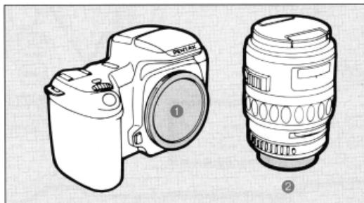
1. 図のように、①のボディーカバーと②のレンズ後カバーを外します。
