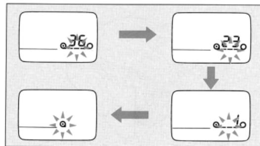
2. 巻き戻しが終了すると、表示パネルの が点滅し、撮影枚数の表示が消えます。
