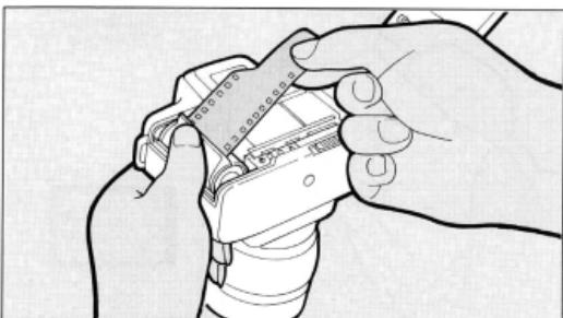
3. 図のように、左手でバトローネを押さえながら、手やフィルム先端がシャッター幕に触れないように気を付けて、フィルムを引き出します。フィルムを引き出し過ぎた場合は、フィルムをバトローネに戻してたるみを取ります。
