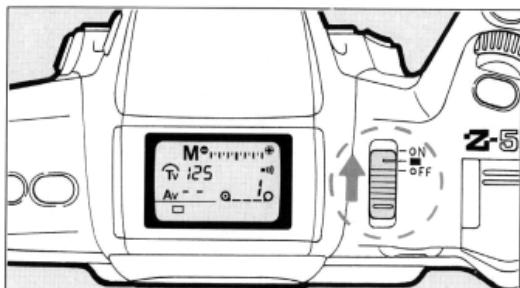
3. 電源スイッチを **[■]** または **[ON]** にし、図のように表示パネルに表示が出ることを確認してください。
