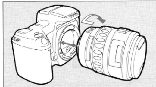
2. ボディとレンズの赤点指標を合わせて、レンズをボディのマウントにはめ込み、レンズを右に回すと「カチッ」と音がしてロックされます。
