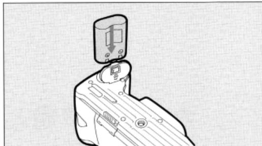
2. 電池の金属接点側を先に、カメラの+表示に合わせて電池を入れ電池ぶたを閉じてください。
