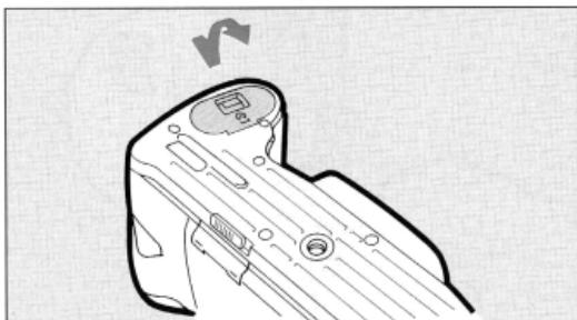
1. 図のように、電池ぶたの開放レバーを矢印の方向へ引いて、電池ぶたを開きます。
