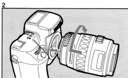
2. ボディとレンズの赤点指標を合わせて、レンズをボディのマウントにはめ込み、レンズを右に回すと「カチッ」と音がしてロックされます。
