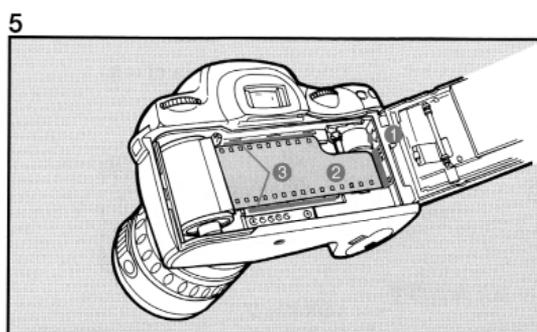
5. 図のように、フィルム先端部を①の赤色先端マークに合わせます。
