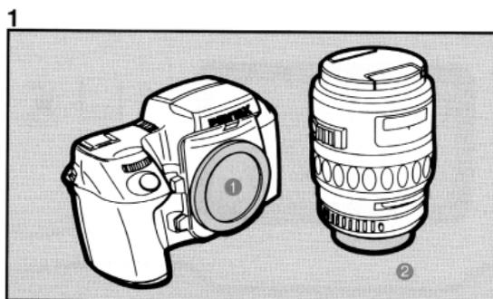
1. 図のように、①のボディカバーと②のレンズ後カバーを外します。
