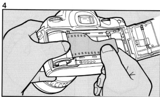
4. 図のように、左手でフィルムを押さえながら、指やフィルム先端がシャッター幕に触れないように気を付けて、フィルムを引き出します。
