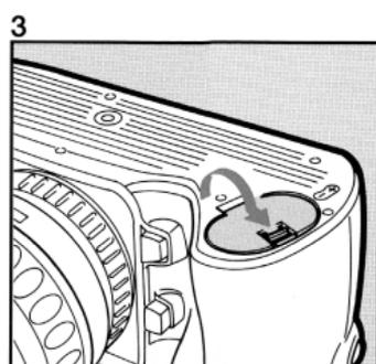
1. 図のように、電池ぶたの開放レバーを矢印の方向へ引いて、電池ぶたを開きます。
