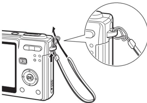
ストラップの細いひもを、ストラップ取り付け部に通して取り付けます。
