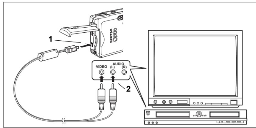
AVケーブルを使用すると、テレビなどビデオ入力端子を備えた機器をモニターにして撮影や再生、あるいは録画ができます。ケーブルを接続するときは、カメラとAV機器の電源を必ずオフにしてください。
