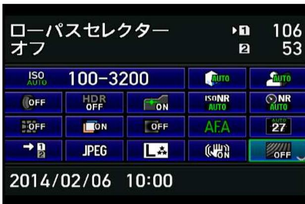
[4] 「ローパスセクター」選択後、後電子ダイヤルを右に回し、
