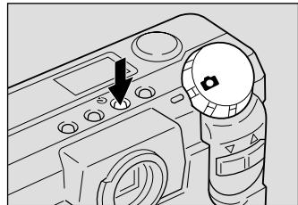
液晶パネルや液晶モニターにセルフタイマーが表示されます。
