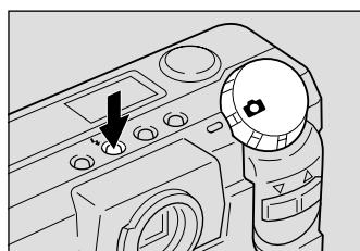
液晶パネルや液晶モニターにフラッシュモードが表示されます。ただし、オートモードの場合は、液晶モニターにのみ
