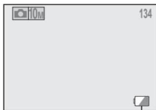
Indicador del nivel de carga de la batería
