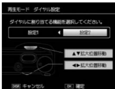
「Mモードダイヤル設定」では、Mモード時のADJ. レバーとアップダウンダイヤルの機能を変更できます。
