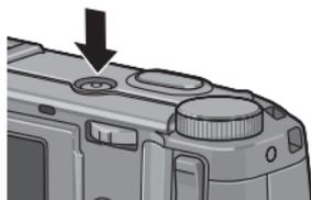
Per spegnere la fotocamera premere nuovamente il tasto di **POWER**. Prima dello spegnimento della fotocamera sarà visualizzato il numero di foto scattate fino a quel momento (se l'orologio della fotocamera non è impostato sarà visualizzato 0; se si spegne la fotocamera una volta modificato l'orologio, la fotocamera visualizzerà il numero di immagini scattate dalla modifica dell'orologio).
