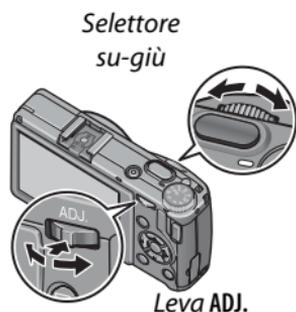
È possibile assegnare voci del menu di ripresa usate di frequente alla leva ADJ. per facilitarne l'accesso. Per visualizzare una voce del menu di ripresa, centrare la leva ADJ. e premere su di esso; è quindi possibile usare la leva e la selettore su-giù per selezionare un'opzione, come indicato alla pagina 116.
