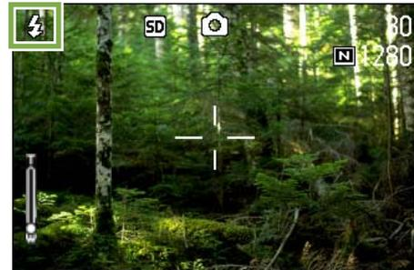
El flash empieza a cargarse. Mientras se carga el flash, la pantalla LCD se apaga y parpadea el indicador de flash. Una vez que termina de cargarse el flash, el indicador se ilumina permanentemente, indicando que es posible tomar la fotografía con flash.
