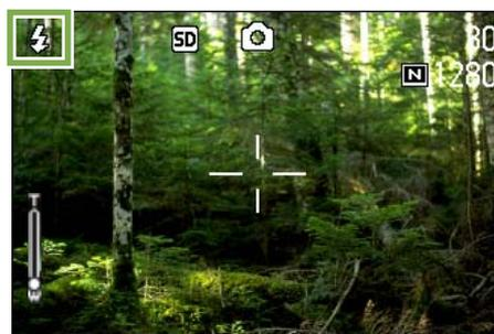
开始充电。在闪光灯充电中液晶显示屏消失，闪光灯的指示灯闪烁。充电完成时，闪烁的指示灯变化成亮灯，则可以进行摄影。
