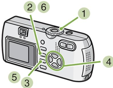
**1 Stellen Sie den Modus-Wählschalter auf (Aufnahmemodus), oder auf **SCENE**. (Szenenmodus), wählen Sie den Modus, und die Kamera ist aufnahmebereit.**
