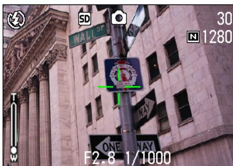
Sobald das Motiv fokussiert ist, werden die Belichtung und der Weißabgleich eingestellt, und das Fadenkreuz in der Mitte des LCD-Monitors wird grün, ebenso die Autofokus-Anzeige in der linken unteren Ecke des Suchers. Überprüfen Sie eine der beiden Anzeigen, um sicherzustellen, dass die Kamera fokussiert ist.
