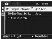
3 Drücken Sie entweder die ▲▼◀▶-Tasten, den ADJ.-Schalter oder das Aufwärts/Abwärts-Einstellrad, um den Punkt auf der Weißabgleichskorrekturkarte zu verschieben und die Farbwerte anzupassen.
