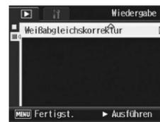
**5** Drücken Sie entweder die **▲▼◀▶**-Tasten, den **ADJ.-Schalter** oder das **Aufwärts/Abwärts-Einstellrad**, um den Punkt auf der **Weißabgleichskorrekturkarte** zu verschieben und die **Farbwerte anzupassen**.
